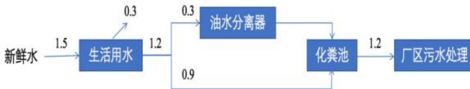
图 2.3-1 项目厂区用水水平衡图 单位： $\text{m}^3/\text{d}$
