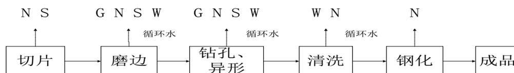
图2 钢化玻璃工艺流程图
